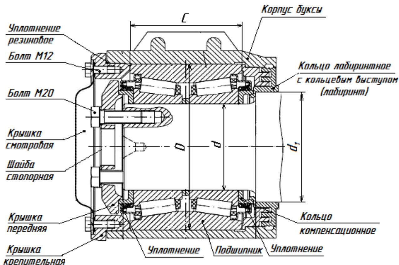
Рисунок 9.5 - Подшипник кассетного типа в габаритных размерах 130x250x160мм торговой марки Бренко в корпусе буксы
