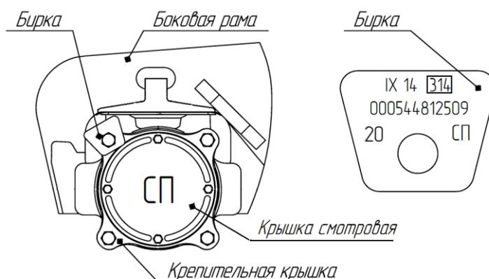
Рисунок 9.4 - Внешние отличительные признаки буксового узла с подшипником сдвоенным
