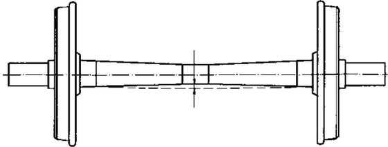
Схема изгиба оси колесной пары
