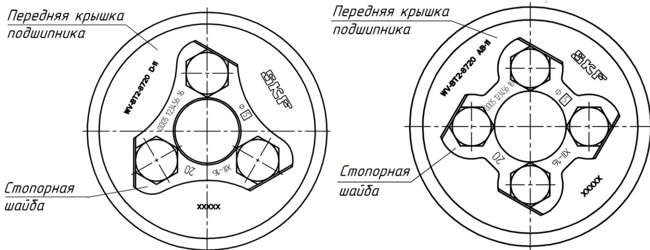
Рисунок 9.12 - Внешние отличительные признаки подшипников кассетного типа в габаритных размерах 130x230x160мм, 130x250x160мм и 150x250x160мм торговой марки SKF под адаптер
