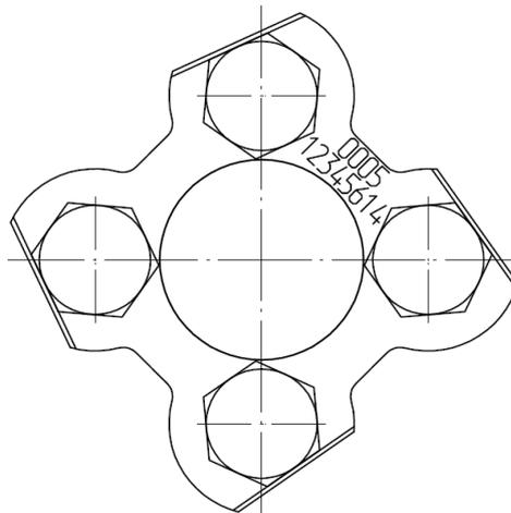
Рисунок 26.9 – Индивидуальный номер колесной пары, нанесенный в два ряда на шайбе стопорной.
