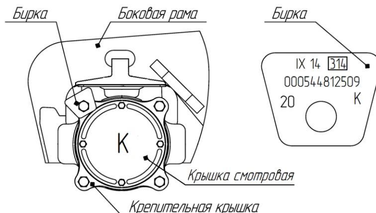
Рисунок 9.11 - Внешние отличительные признаки буксового узла с подшипником кассетного типа в габаритных размерах 130x250x160 мм торговой марки SKF
