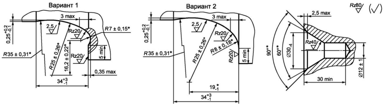
\*Размеры обеспечиваются инструментом
