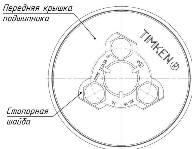
Рисунок 9.14— Внешние отличительные признаки подшипников кассетного типа в габаритных размерах 150x250x160мм под адаптер торговой марки TIMKEN
