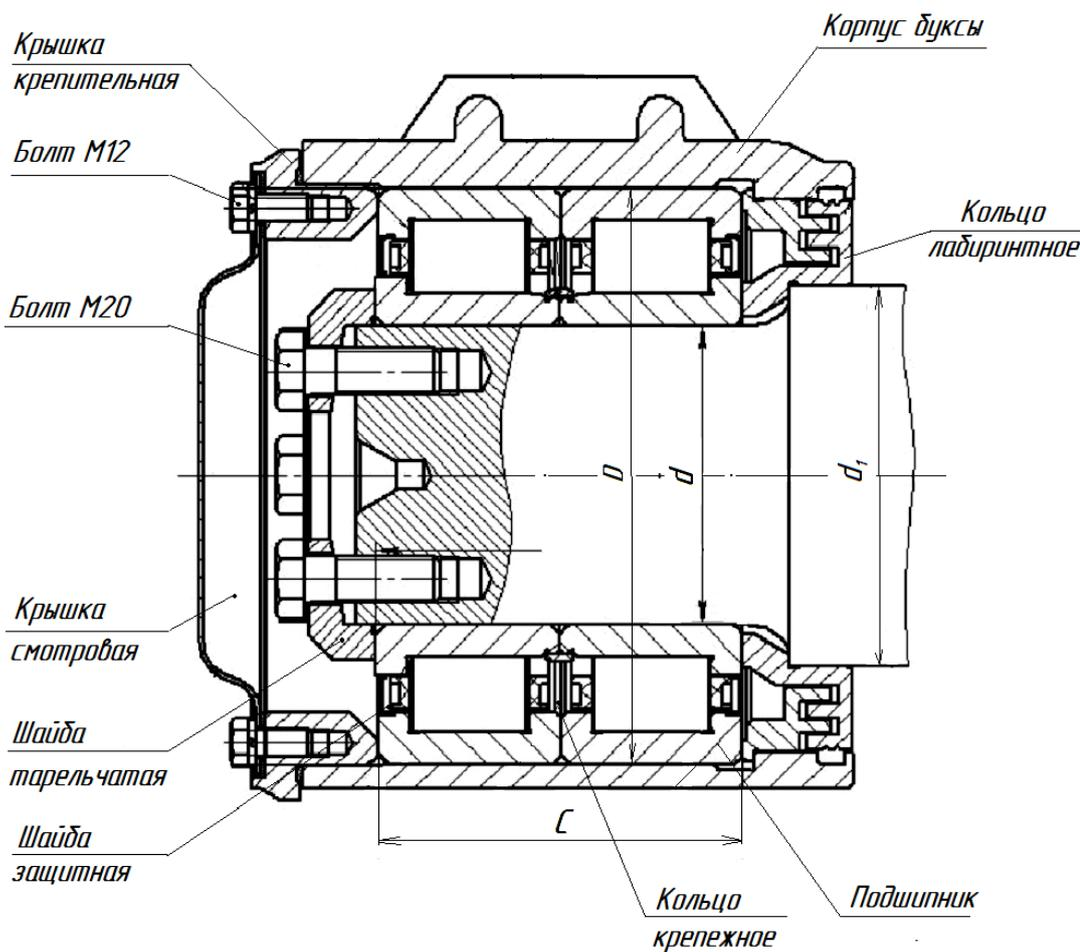
Рисунок 9.3 - Буксовый узел с подшипником сдвоенным
