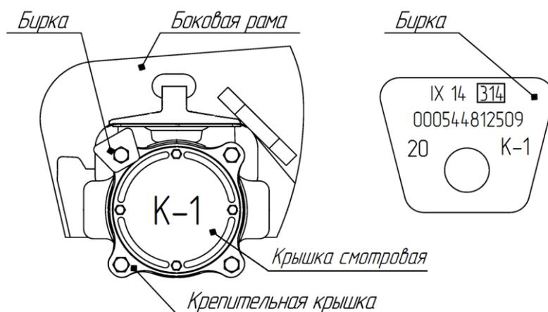
Рисунок 9.7 - Внешние отличительные признаки буксового узла с подшипником кассетного типа в габаритных размерах 130x250x160мм торговой марки Бренко
