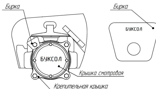
Рисунок 11.1 - Отличительные признаки буксового узла с подшипниками роликовыми цилиндрическими, заправленного смазкой Буксол или ЗУМ
