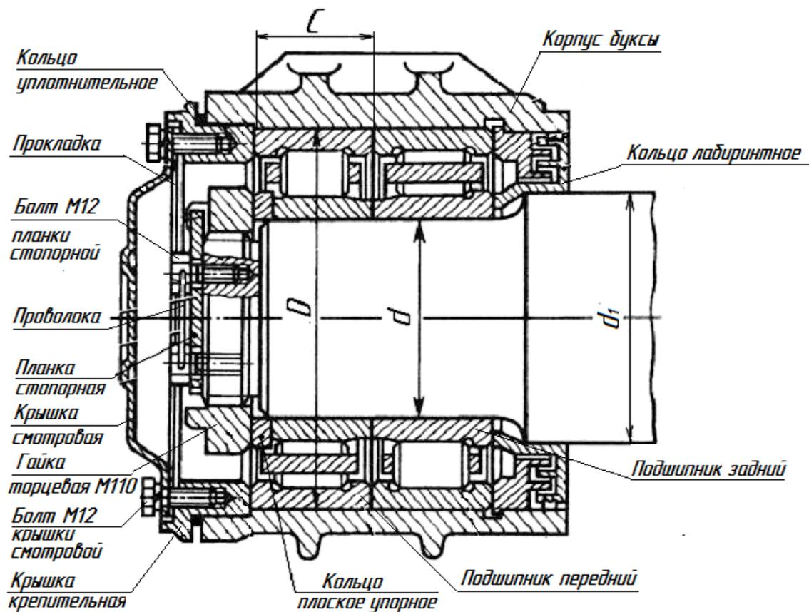
Рисунок 9.2 - Буксовый узел с двумя подшипниками роликовыми цилиндрическими с торцевым креплением гайкой торцевой М110
