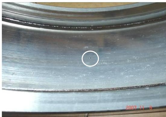
Визуальный контроль. По внешнему виду дефект имеет вид кратера, при рассмотрении с использованием увеличительного стекла доньшко кратера темного или серого цвета со следами оплавления.
