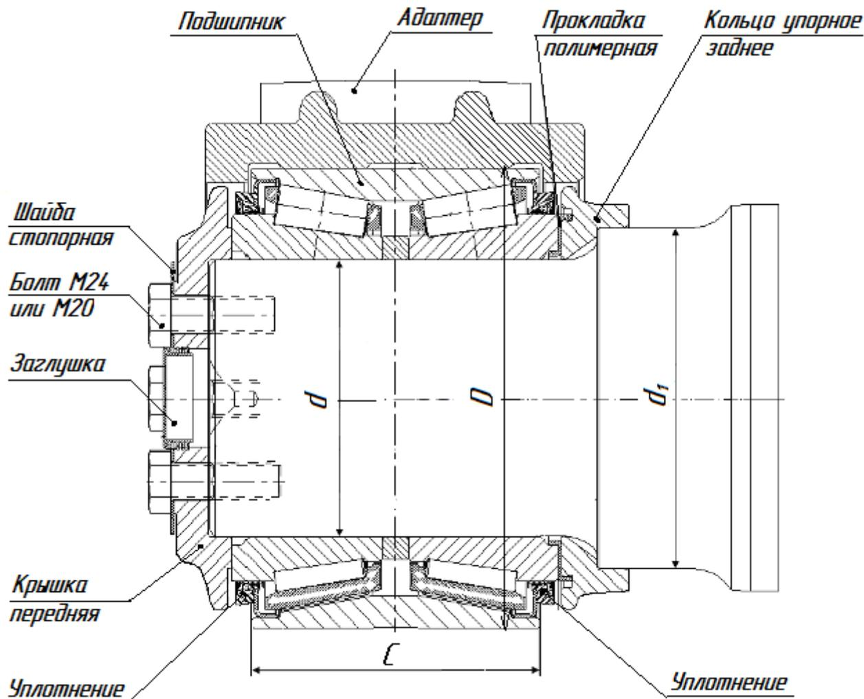
Рисунок 9.10 - Подшипники кассетного типа в габаритных размерах 130x230x150мм, 130x250x160мм и 150x250x160мм торговой марки SKF под адаптер.
