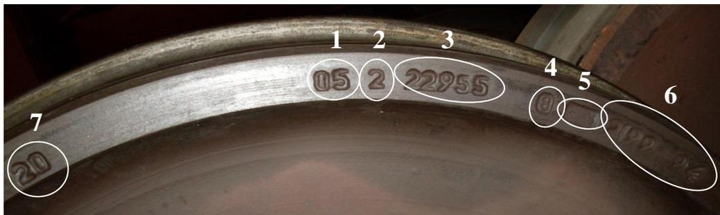
1 - две последние цифры года изготовления колеса; 2 - марка стали; 3 - номер плавки; 4 - условный номер предприятия-изготовителя колеса (номер или его торговая марка); 5 - приемочные клейма; 6 - порядковый номер колеса по системе нумерации предприятия-изготовителя; 7 - код государства-собственника колеса, наносится в двух местах: первое клеймо - на расстоянии 150...200 мм перед основной маркировкой, второе - с диаметрально противоположной стороны.
