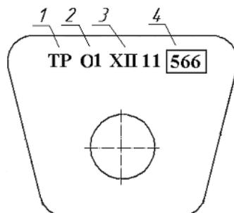
1 - знак проведения текущего ремонта колесной пары; 2 - О1 или О2 - знак восстановления профиля поверхности катания колес (если производилось); 3 – дата проведения текущего ремонта и восстановления профиля поверхности катания колес (месяц римскими цифрами и две последние цифры года) 4 - условный номер ремонтного предприятия, которое провело текущий ремонт и восстановления профиля поверхности катания колес.
