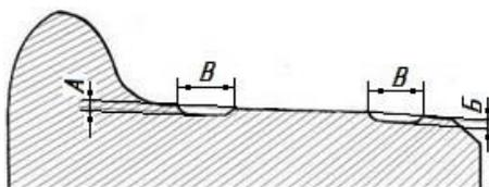
Рисунок 12.1 – Кольцевые выработки на поверхности катания колес
