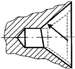
Схема повреждения центрального отверстия
