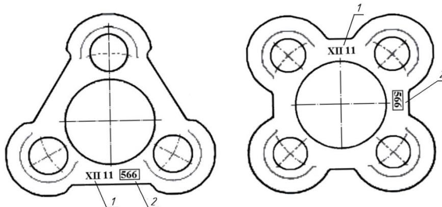
1 – дата проведения среднего ремонта колесной пары (месяц римскими цифрами и две последние цифры года); 2 - условный номер ремонтного предприятия, которое произвело средний ремонт колесной пары.
