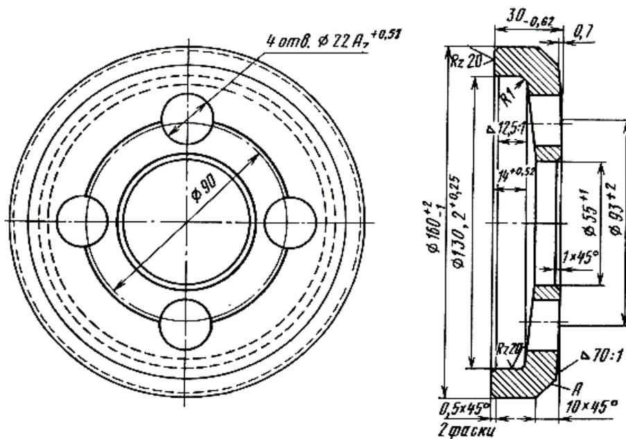
Для крепления четырьмя болтами M20 на шейке оси типа РУ1Ш
