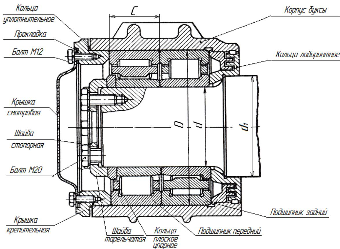
Рисунок 9.1 - Буксовый узел с двумя подшипниками роликовыми цилиндрическими с торцевым креплением шайбой тарельчатой и болтами М20
