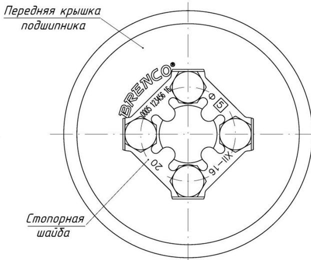
Рисунок 9.8 - Внешние отличительные признаки подшипников кассетного типа в габаритных размерах 130x230x150мм, 130x250x160мм и 150x250x160мм под адаптер торговой марки Бренко
