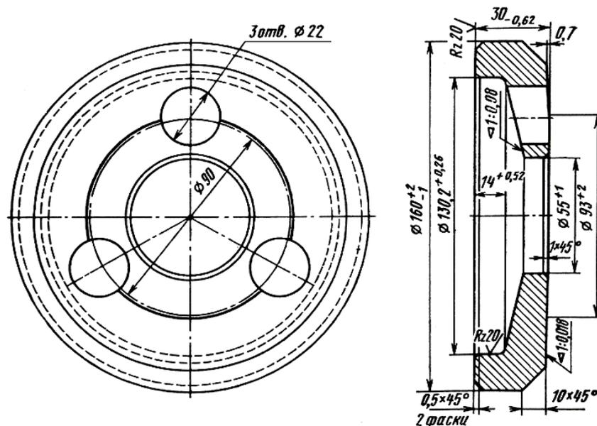
Для крепления тремя болтами M20 на шейке оси типа РУ1Ш
