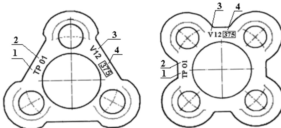
1 - знак проведения текущего ремонта колесной пары; 2 - O1 или O2 - знак восстановления профиля поверхности катания колес (если производилось); 3 – дата проведения текущего ремонта и восстановления профиля поверхности катания колес (месяц римскими цифрами и две последние цифры года); 4 - условный номер ремонтного предприятия, которое провело текущий ремонт и восстановления профиля поверхности катания колес.
