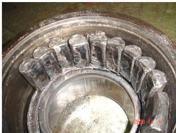
Визуальный контроль, использование напольных средств автоматического контроля буксовых узлов в пути следования. При движении поезда искрение, выделение дыма, запах гари, движение колесной пары юзом.
