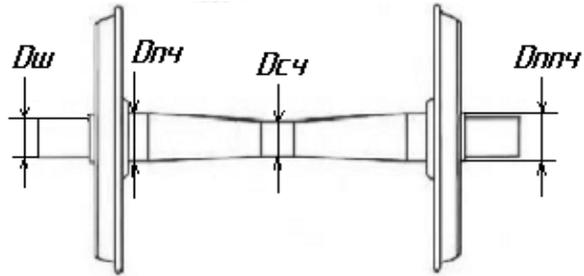
Измерение геометрических параметров оси.
