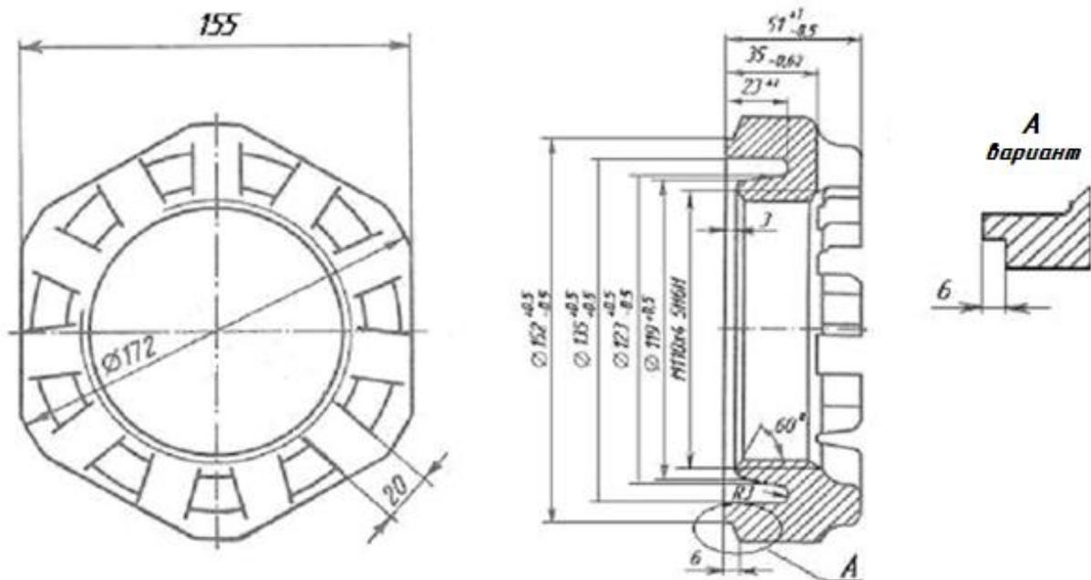
Рисунок 10.7 - Гайка торцевая М110х4 5Н6Н
