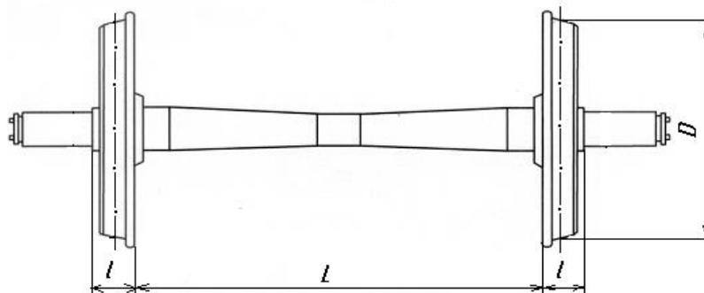
Рисунок 8.2 - Колесная пара типа РУ1-957-Г без буксовых узлов
