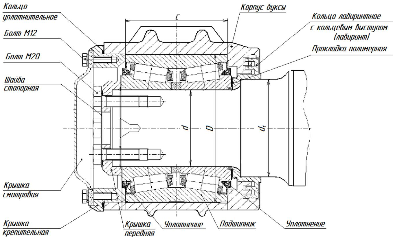
Рисунок 9.9 - Подшипник кассетного типа в габаритных размерах 130x250x160мм торговой марки SKF в корпусе бусы
