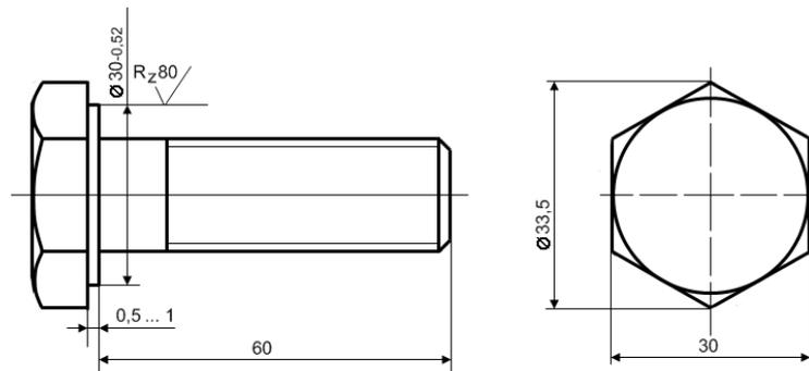
Рисунок 10.11 - Болт М20-6gx60.4.8 с резьбой, выполненной методом накатки
