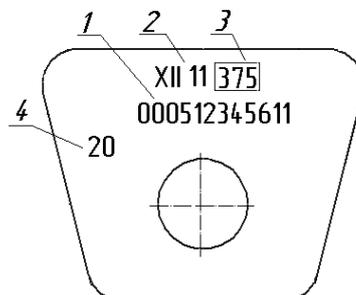
1 - индивидуальный номер колесной пары; 2 - дата проведения среднего ремонта колесной пары (месяц римскими цифрами и две последние цифры года); 3 - условный номер ремонтного предприятия, которое произвело средний ремонт колесной пары; 4 - код государства-собственника колесной пары.
