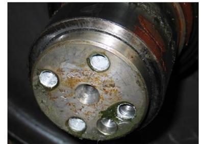
Следы герметика в резьбовых отверстиях осей
