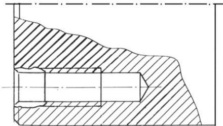
Механическое повреждение резьбы М20 осей РУ1Ш и РВ2Ш, резьбы М24 осей РВ2Ш
