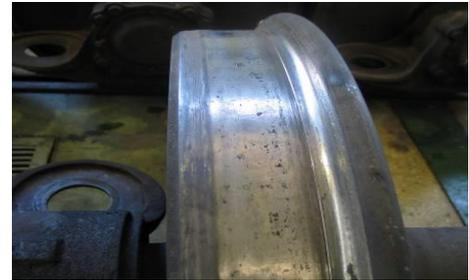
Визуальный контроль и замеры. Измерение глубины («А» или «Б») и ширины («В») производят с помощью глубиномера и линейки.
