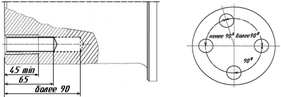
Измерение глубины отверстий и их смещения.
