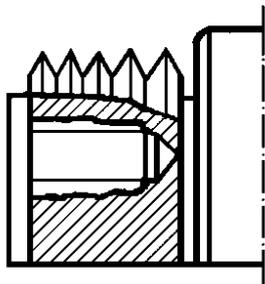
Механическое повреждение резьбы М12 осей РУ1
